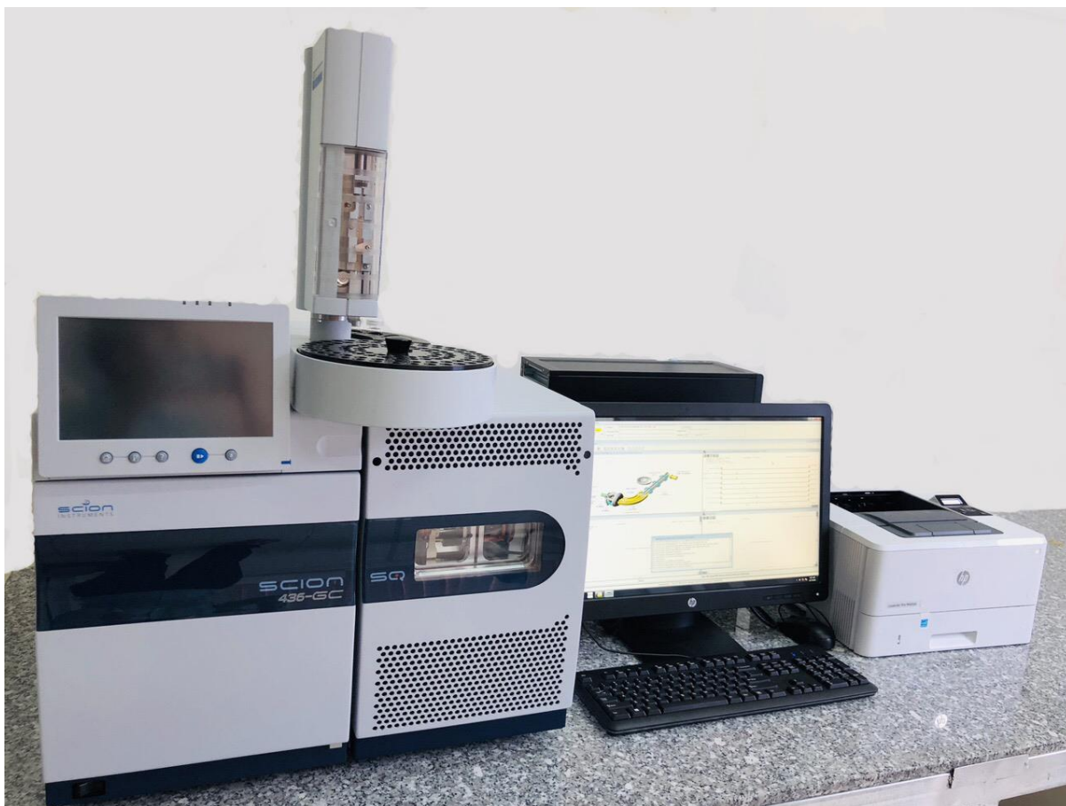
Hình 5. Hệ thống sắc ký khí khối phổ bao gồm máy sắc ký khí, khối phổ, máy tính và máy in của BIWASE
