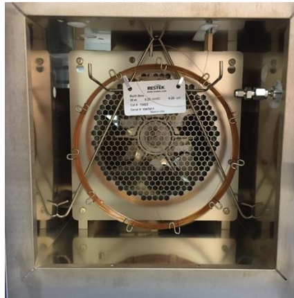
Hình 2. Cột silica hợp nhất của GC, Rxi-5ms, 30 m x 0.25 mm x 0.25 \mu m.
