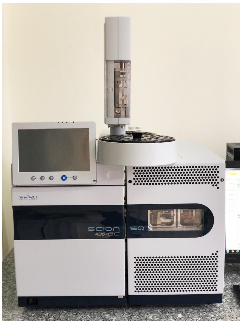
Hình 4. Thiết bị sắc ký khối phổ (Scion 436-GC và SQ) với bộ lấy mẫu tự động 8400. Thiết bị này gồm có đường dẫn ion không thấu kính, ion quang nhiệt và đầu dò EDR cho độ nhạy cao hơn.
